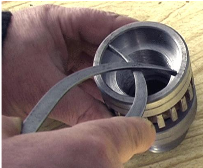
Рисунок 2.10-2 – Вимірювання внутрішніх розмірів кронциркулем
