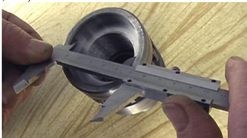
Рисунок 2.14 – Вимірювання отвору деталі
