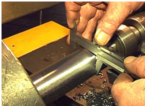
Рисунок 2.4 – Вимірювання деталі штангенциркулем після обробки
