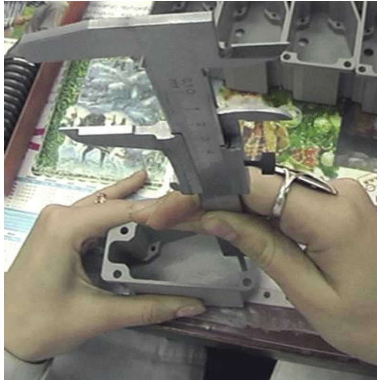
Рисунок 2.15 – Вимірювання розміру глибини деталі
