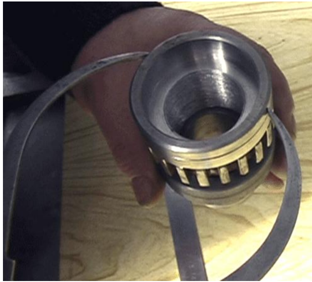
Рисунок 2.10-1 – Вимірювання зовнішніх розмірів кронциркулем
